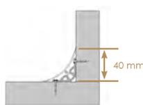
Système de profilés mâle/femelle destiné à arrondir les angles entre deux murs ou entre le mur et le plafond.
