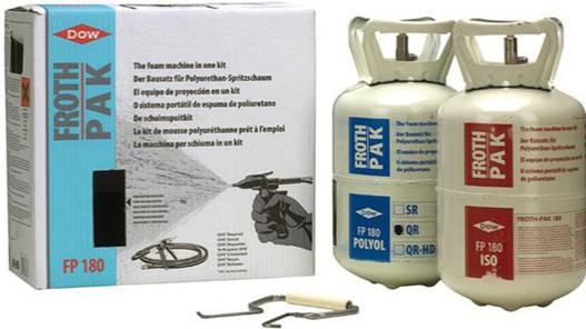
La technique FROTH-PAK basée sur le procédé « frothing » assure une expansion (x 10) de la mousse dans le mélangeur (gicleur). Ainsi, on obtient en premier lieu un état crémeux, qui de suite subit une deuxième expansion (x 3) suite à une hausse de température dans le mélange. La mousse polymérise dans les secondes qui suivent l'application.
