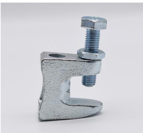
Le crampon serre-joint permet des fixations rapides sur les poutres métalliques. Pour le supportage de colliers, passer une tige filetée dans le trou lisse et la bloquer par 2 écrous. À la différence avec un taraudage, il est possible de régler la hauteur, après montage, en desserrant l'écrou inférieur et en serrant l'écrou supérieur sans vissage.
